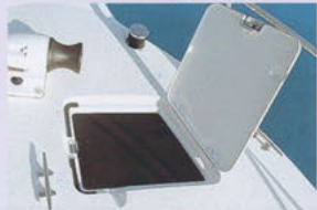
●ローブロッカー パウデッキの下部にローブ類を収納できます。
