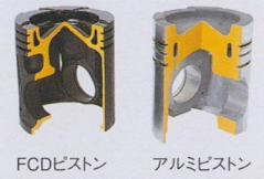
アルミピストン対FCDピストンの強度比較
