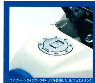
エアブレンタイプタンクキャップを装備した、3ℓ燃料タンク。
