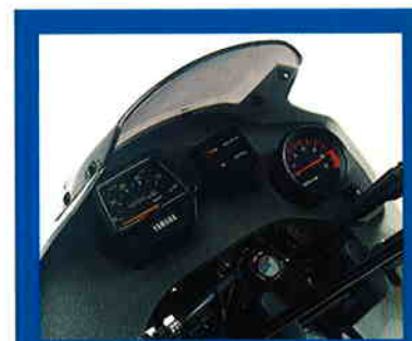
タコメーターを装備した見やすいメーターパネル (写真はTDR50)
