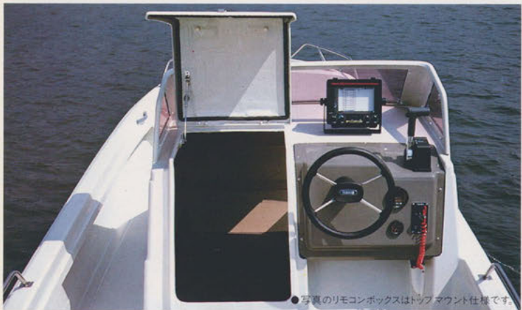
キャビン: バウからスタンまでをオープンデッキとして使えるよう、キャビンを右舷寄りに設計。操作性の高いステアリング、スロットルレバー、メーター類などを機能的にまとめました。また、リモコンボックスにはトップマウント仕様とサイドマウント仕様の2タイプがあります。
