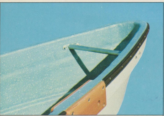
艀系留用バーは系留時の作業をスムーズにし、かんざし取り付け等の他用途への応用もできます。
