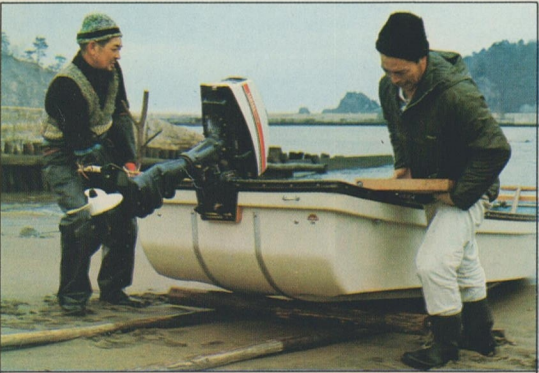
後部にまる味をもたせたので、砂浜へのコロ引き上げがスムーズに出来ます。
