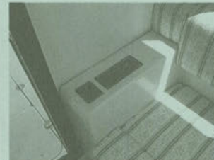
●マリンエアコン* (吹出し口はキャビン両舷にあります。) *シートは実物とは異なります。
