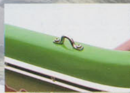
けい索を容易にするデッドアイ、スターンの両サイドに。
