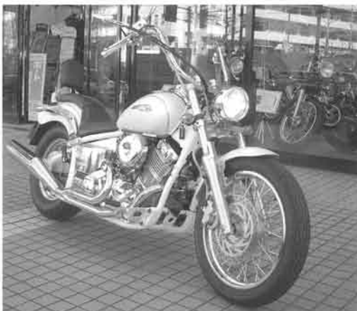
ナロー・エイブハンガーバー、パワーとサウンドを追求した2-フルエキゾーストのスラッシュカットマフラーなど17点のパーツが施されている
