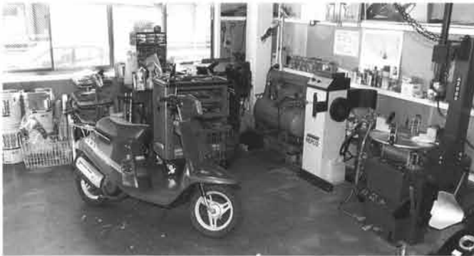
モトクロスの全日本選手権を追うチームも抱えているため、サービス工場は機器設備、広さは十分。センタースタンドがないバイクでも整備しやすいよう、リフトの代わりにウインチを使っているのが特徴
