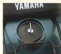
スライド式キーキャップ付フューエルタンクキャップ
