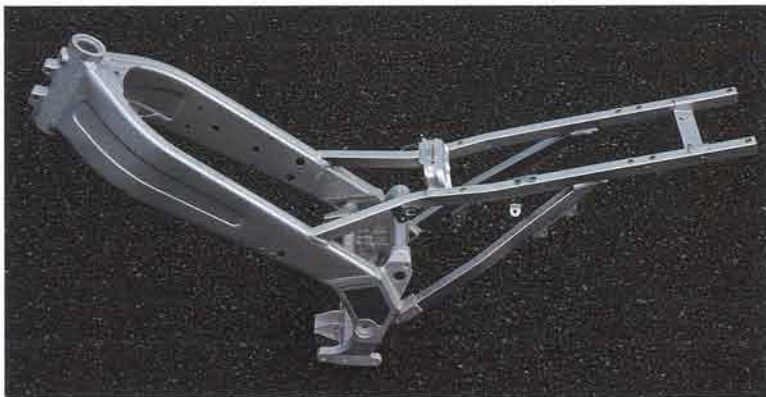
RZ250RRに比べ約40%軽く、40%剛性アップしたアルミ・デルタボックスフレーム。'86TZR250のフレームの基本にもなったこの先進のフレームが、かつてないマン・マシン一体感を生み出す
