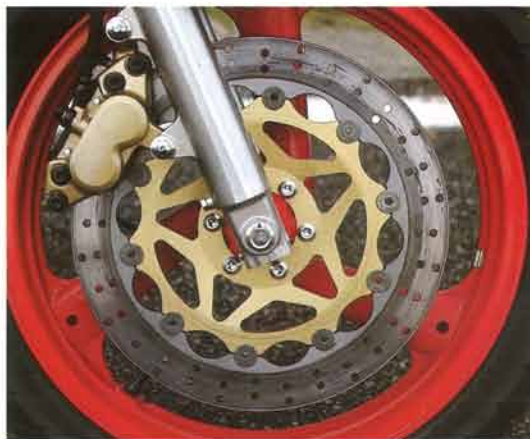
YZR500と同サイズの320mm大径ディスクをフローティングマウントしたフロントブレーキ
