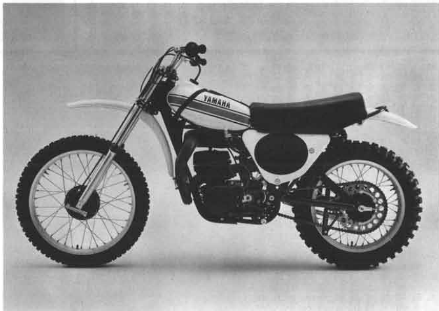
●全長2110mm ●全幅890mm ●全高1160mm ●車重119kg ●エンジン・トルクインダクション・246cc ●ボア×ストローク70×64mm ●圧縮比7.4 ●最高出力34PS/8000rpm ●最大トルク3.1kg-m/7500rpm ●リターン式5段変速 ●懸架方式テレスコピック・オレオ(前)モノクロス・サスペンション(後) ●タイヤ3.00-21(前)4.00-18(後)
