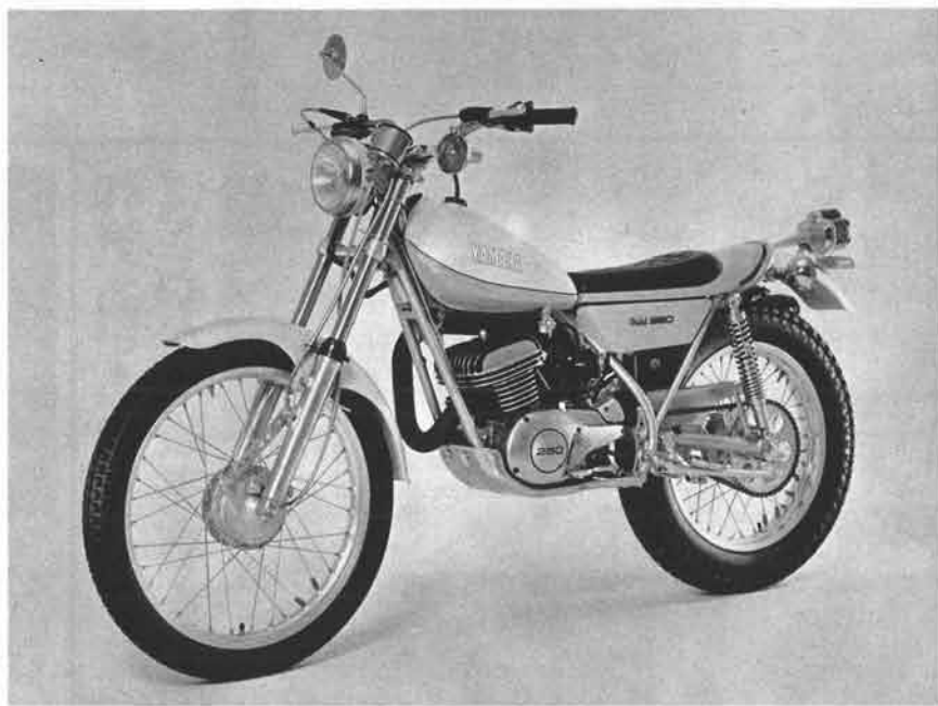
●全長1980mm ●全幅840mm ●全高1125mm ●車重97kg ●空冷2サイクル単気筒・246cc ●ボア×ストローク70×64mm ●圧縮比6.0 ●最高出力16.5PS/6000rpm ●最大トルク2.1kg-m/5000rpm ●リターン式5段変速 ●タイヤ寸法(前)2.75-21((後)4.00-18
