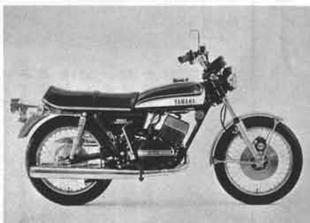
RD350PRO ：'73年1月発売。トルクインダクションエンジンを採用。前輪ディスクブレーキは、'72年4月のRX350PROから。
