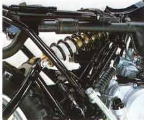
新採用のモノクロスサスペンションでリヤホイールトラベルは20mmもアップ
