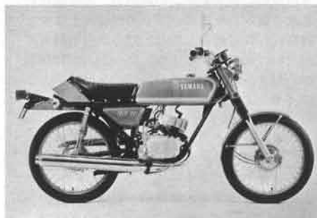
FX50：'72年5月発売。7ボーンフレームからWクレードルフレームに一新
