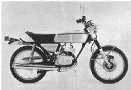
RD50：'74年3月発売。このRDから前輪油圧ディスクブレーキを装備。50ccロードスポーツモデルとしての個性を一層明確にしている
