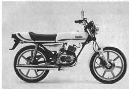
RD50SP：'78年3月発売。50ccでは初めてキャストホイールをはいてデビューした現在のRD50SP
