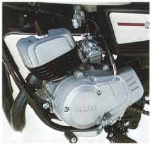
5. PS / 8000rpmとパワーアップしたエンジン。左右のクランクケースカバーもデザインを一新
