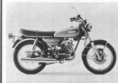
RD125：'73年からはますます洗練されて呼称もRDに、フロントにディスクブレーキを装備('73年12月)
