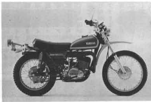
'73年12月発売の「DT250」。アップマフラーを右側に、フロントフェンダーをアップ。リヤサスはサーマルフロータイプ
