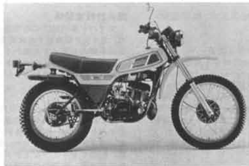
現在の「DT250」'77年2月にフルモデルチェンジ。モトクロスサーYZと同機構の「モノクロスサスペンション」を装備
