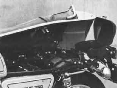
Grabバーがついたシートと、内部に新設された小物入れ
