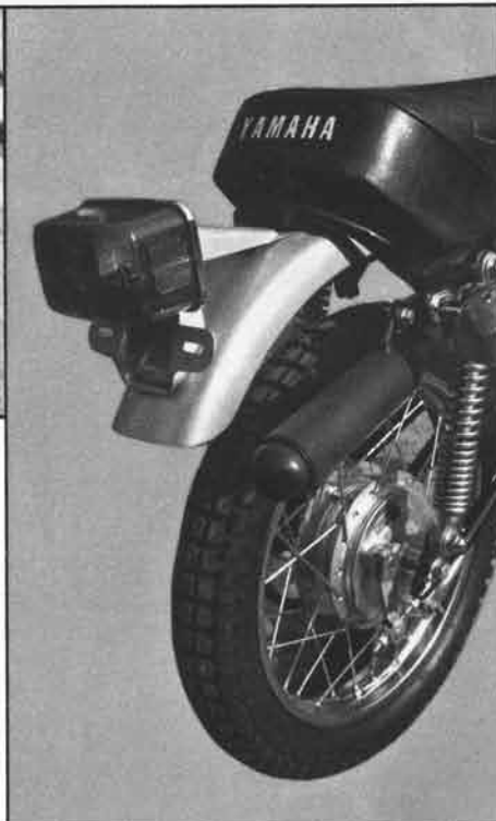
▶DT系に準じたマフラー。消音効果を高めると同時に排気汚れ防止にも効果をあげています。テールランプは角型を採用
