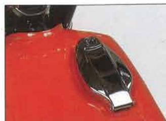
安全性の高い埋込式後方ヒンジの燃料タンクキャップ。キー付
