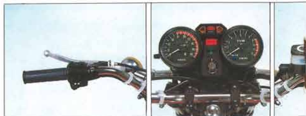
45度傾斜で見やすく配置された新設計のメーター。ハンドルグリップは感触のよい軟質ゴム製を採用
