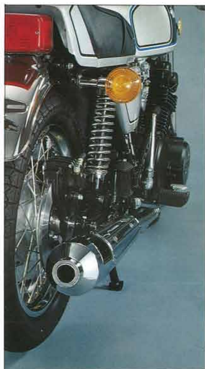
3気筒並列前傾のエンジンからメカニカルな曲線を描く3本のエキゾーストパイプは1本のマフラーに集合する。この角度からも、エンジン巾がせまくスリムなまとまりのよさがよく分かる
