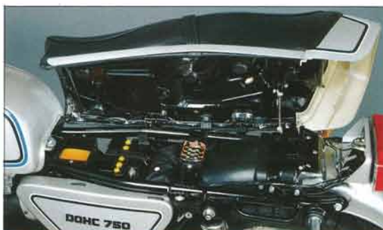
シートは横開き式でストッパーつき。シートうらに車検入れがあり、ツールは中央部に収められ出し入れは容易
