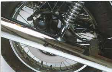
後輪のディスクブレーキまわり。マフラーは左右連結式となっている
