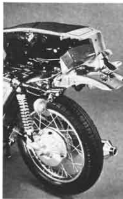
2本のボルトを外すだけで、リヤフェンダーは跳上げられる
