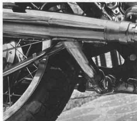
低中速域で出力を増し、排気消音にも効果の大きい左右連結式マフラー
