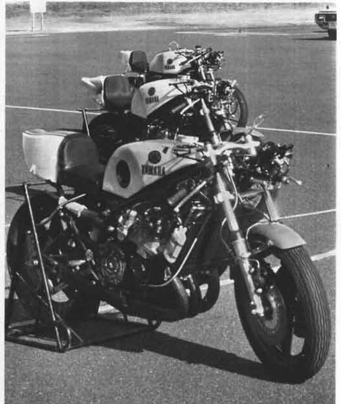
手前からYZR750、YZR500、YZR350の強力マシーン。3台合計1.6ℓのパワーは250馬力を越える。まさに圧巻!
