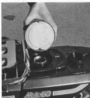
オイルタンク容量は、1.2ℓ。新設のオイル点検窓の中位のところで1ℓの補給ができる親切設計
