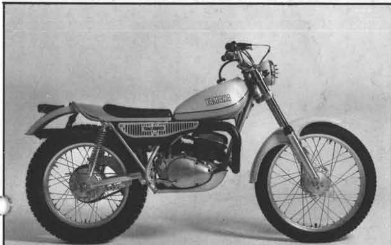
輸出モデルとして完成した「ヤマハトライアルTY250」。ライディング・ポジションの徹底したバランスしやすさを図り、車体重量は93kgという軽量さでまとめている。
