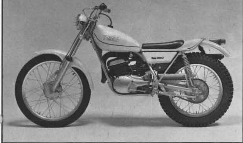
輸出モデルとして完成した「ヤマハトライアルTY250」。ライディング・ポジションの徹底したバランスしやすさを図り、車体重量は93kgという軽量さでまとめている。
