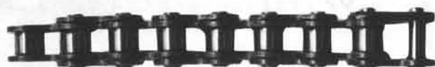
▲ドライブ・スプロケットの大型化にそなえてのドライブ・チェーンつぎ足し用 (8駒)
