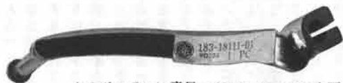
▲スポーティに素早いギヤ・チェンジを可能とするバー式のチェンジ・ペダル
