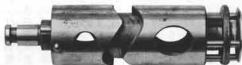
▲166-18541-62 ギヤ・チェンジをロータリー式からリターン 式に改造するカム・シフト ¥400
