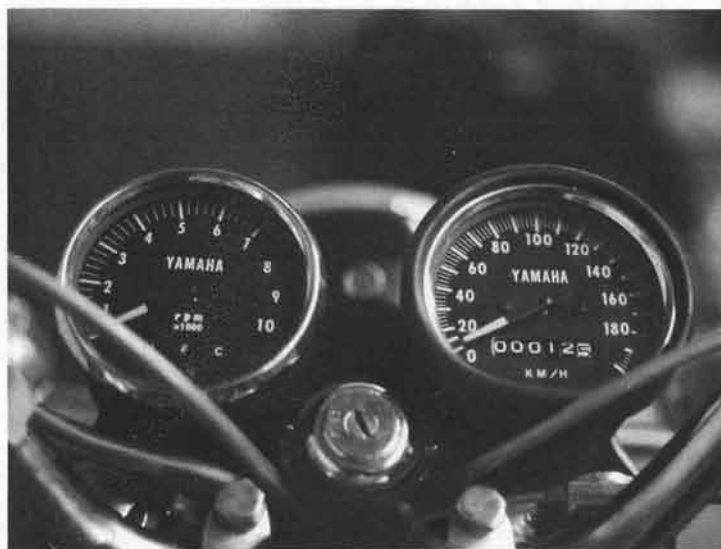
▲時速200キロの目盛りがあるスピードメーターとタコメ ターの間、扱いやすい位置にメインスイッチが設けられた。
