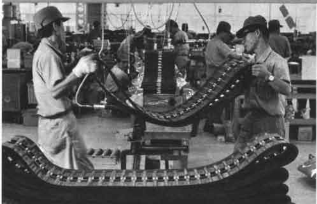
組立ラインの先端では、まず足まわりの組立てが開始される。
