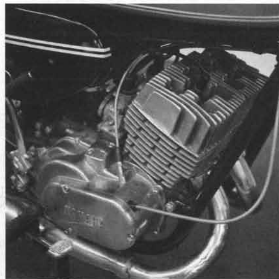
アルミシリンダーの白いエンジンと、分解整備が簡単な上下分割式のクランクケース。
