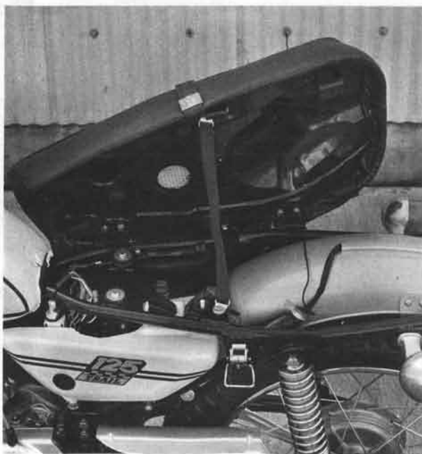
▲左横のフックをはずすだけで、簡単にシートが開けられ、オートループオイルの補給も容易。
