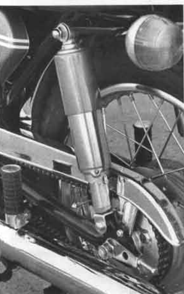
▲リアクッションは3段切換式バネ圧を自由に調節できる。
