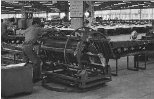
足まわりが完成したボディは、クルリとひっくりかえされ、上部機構のとりつけへ。
