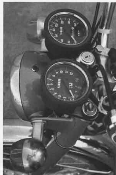
▲操作しやすい場所に設けられたメインスイッチには、夜間スイッチの位置がなくなり、ライトスイッチは左ハンドルにまとめられた。
