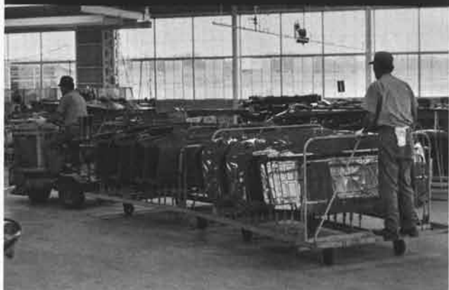
熔接や塗装のおわったフレームが、組立ラインに入ってくる。
