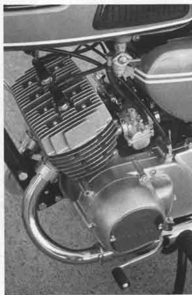
▲毎分7,500回転で21馬力、7,000回転で2.05靨/靨と、180クラスでは驚異の出力性能を持つ2気筒エンジン
