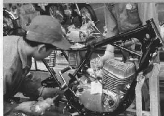
②組立てられたフレームに18.5馬力のエンジンがのせられ…
