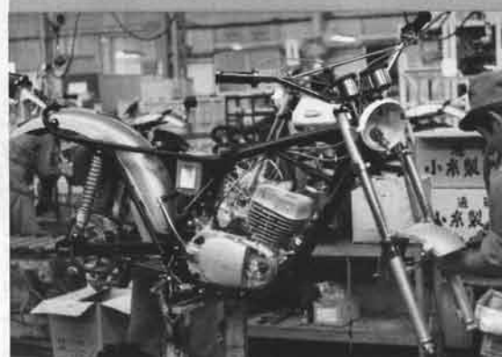
⑥メーター類とランプボディ、フロント・フェンダーが付き…
