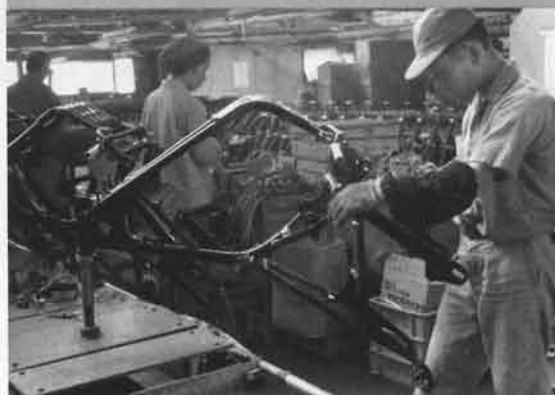
①フレーム本体にリアのスイングアームが組付けられる。
