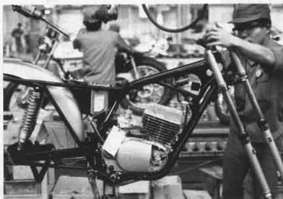
④フロント・フォークがつく。車体の骨格がはっきりしてきた。
