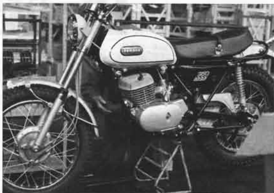
②ツヤ消しの耐熱特殊塗料を施したエキパイが取付けられ…
