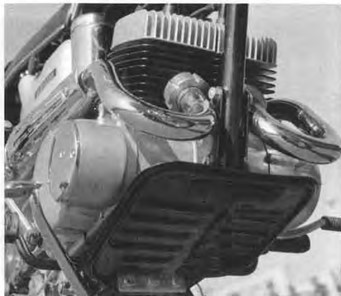
荒地でも思いのままに走れるよう5（ファイブ）ポート2気筒、2キャブ、オートループの13.8馬力の2サイクルには頑丈なエンジンガード付だ。
