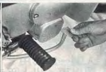
②ブレーキ調整 チェーン調整後には必ず後輪ブレーキを調整します。ペダルの踏み代は20～30mmに
