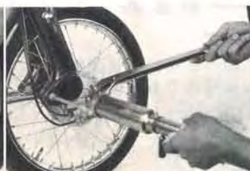
⑨グリースアップ グリースがきれたからといっても多すぎないように。とくにブレーキカムへの給油には注意が肝要。
