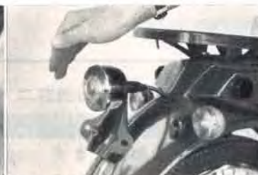
⑤後輪ブレーキの調整と同時にストップランプの点灯確認を忘れぬこと。
