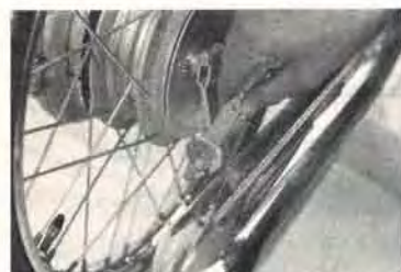
④ブレーキカムレバーにつながるアジャスターで正規の遊びをもつように調整します。
