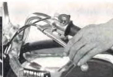
⑥クラッチレバーの遊び調整 レバーをにぎり クラッチが切れはじめる(手応えでわかる)までを2～3mmとします。
