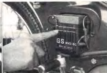
⑦バッテリー液の点検 少ないときは蒸溜水を補給。必ず規準線内にあるようにします
