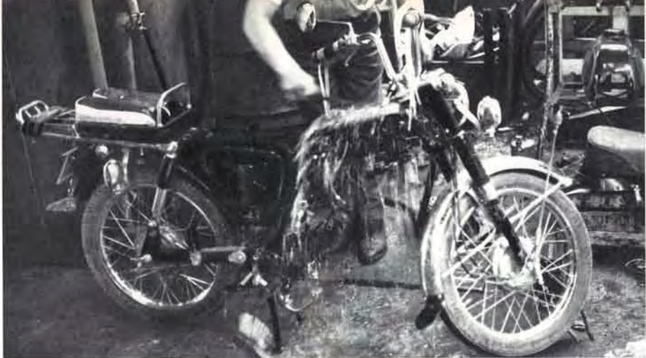
②次いで燃料タンク オイルタンクを外し 車体はそのまま水洗いする
