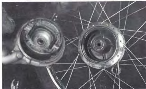
⑧クランクケースカバー内にまで侵入していた泥土も プレーキ内には不思議に水も 泥土もみられなかった ヤマハの特許 完全防水防塵機構の構造は確かだ……
