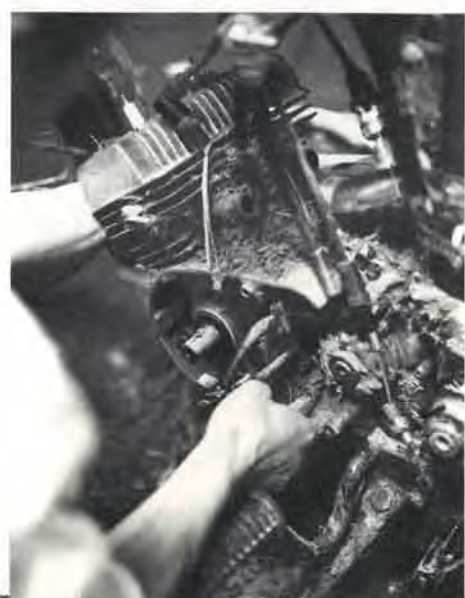
二度手間を省くために 附着した泥土はそのままオーバーホールにかかる
