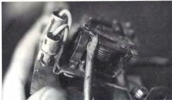
⑦水につかったバッテリー レギュレータはショートを起こして再生はきかない レギュレータのカットアウトリレーは完全に焼損している もちろん新しい部品と交換する
