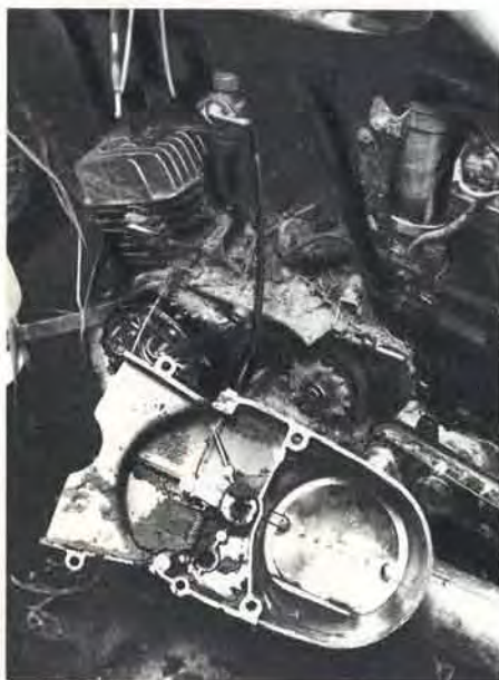
クランクケースカバー内も 泥 泥 泥 いかにひどい水禍であったかが分かる
