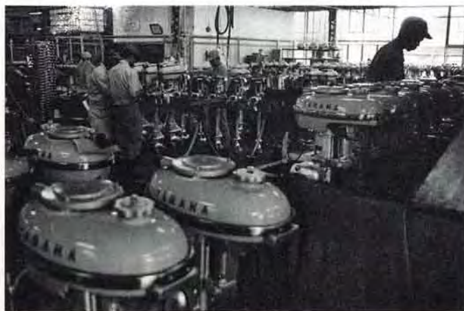
漁業に、レジャーにと、需要が急増し、いまや生産も急ピッチ。組立てられた船外機は水槽でテストされる。
