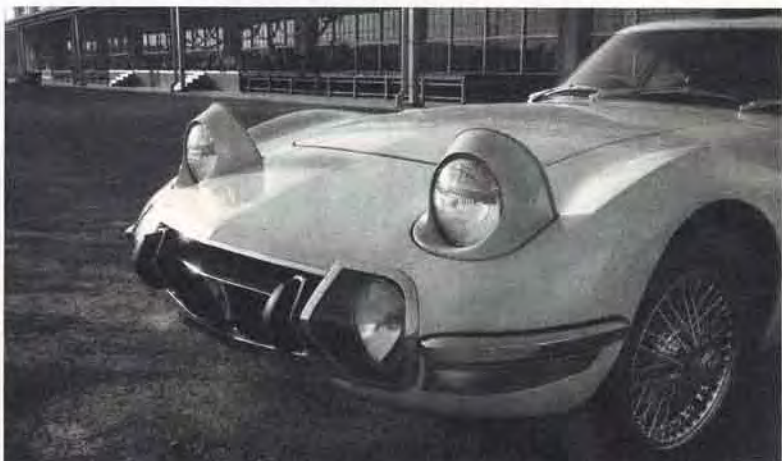
ヘッドランプはモーターによってひき起され4灯式となる。もちろん日本の車として初めての試みである。
