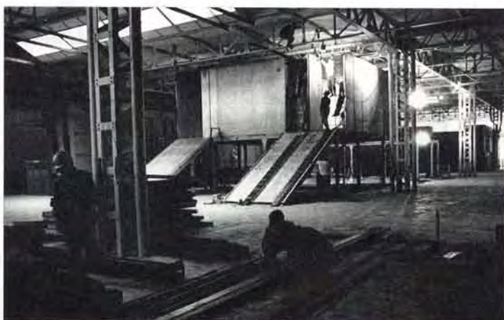
脱脂、水洗い、塗装、乾燥焼付けまで一貫して行なわれる塗装工場。
