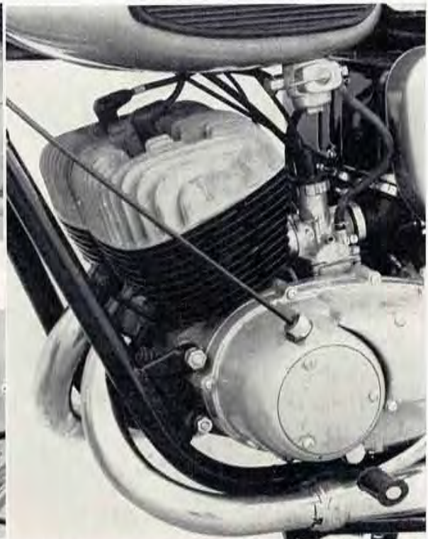
2サイクル最大 2キャブ <オートループ>潤滑の26馬力2気筒エンジン 変速機は市販車としてヤマハだけがもつ5段
