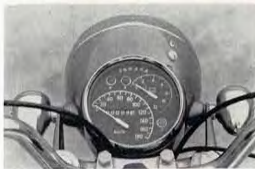
回転計と速度計がコンビとなったメーター ラバーを介して取付けられており 振動に強くなっています
