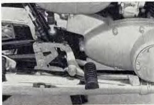
後輪ブレーキはリンク機構を介しワイヤーで作動しますので 効き味はまた格別です
