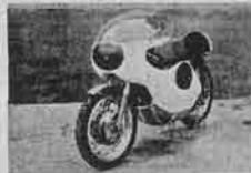
このRD250は、250ccのエンジンを搭載し、最高速度は時速200km/hに達する。また、軽量なボディと優れたハンドリングにより、レースに最適な性能を発揮する。
