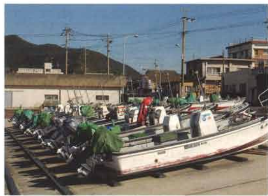
枕崎の港では16尺に20馬力の主機と6馬力の補機を搭載した和船がずらりと並び
