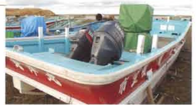
W-336に80馬力の2基掛けが主流。写真のように4スト+2ストも珍しくない
