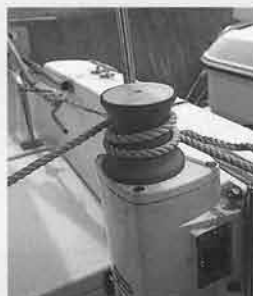
パワーのアンカーをアフトデッキで操作するための電動ウインチシステムで、フィッシングボートには人気の機装
