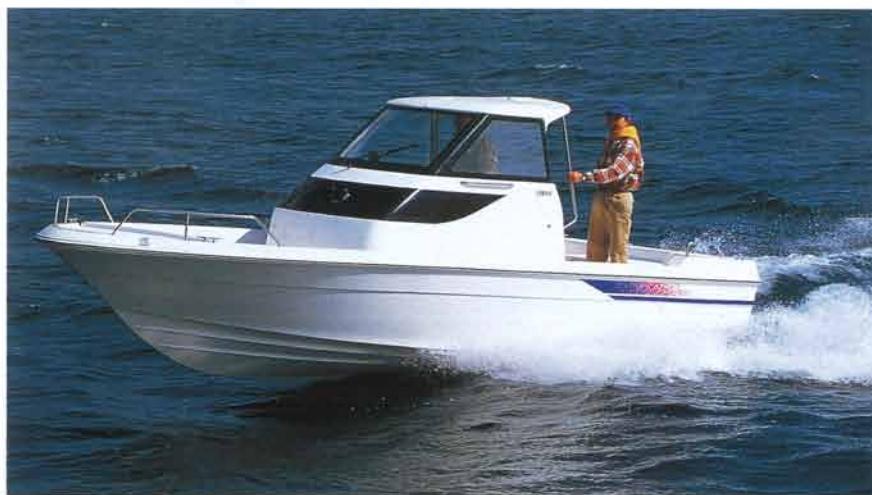
UF-23 S/D ● 全長: 7.68m (バウスプリットを含む) ● 全幅: 2.40m ● 総トン数: 5トン未満 ● 最大馬力: 105PS ● 航行区域: 限定沿海 ● 定員: 10名
