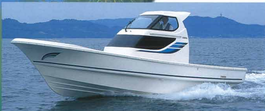
DX-27E ● 全長: 8.30m ● 全幅: 2.30m ● 総トン数: 5トン未満 ● 最大馬力: 130PS ● 航行区域: 限定沿海 ● 定員: 7名
