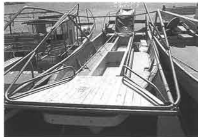
白神社長が考案した、酸処理作業の機装。船の上に揚がった網が、デッキ中央に設けられた水槽のなかで薬品に浸り、その後、艦の木製デッキから海面に落とされる
