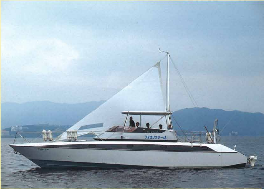
(フィロソファ-45) ●全長：15.37m ●全幅：3.55m ●全深さ：2.26m ●総トン数：10トン ●最大馬力：200PS×2(主機)+9.9PS(補機)：船外機
