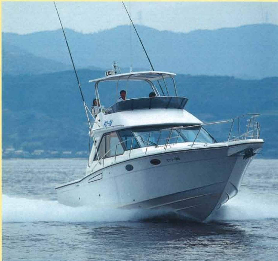
(PC-36) ●全長：13.33m ●全幅：4.04m ●全深さ：2.18m ●総トン数：12トン ●最大馬力：360PS×2 ●エンジン：SX-629KM
