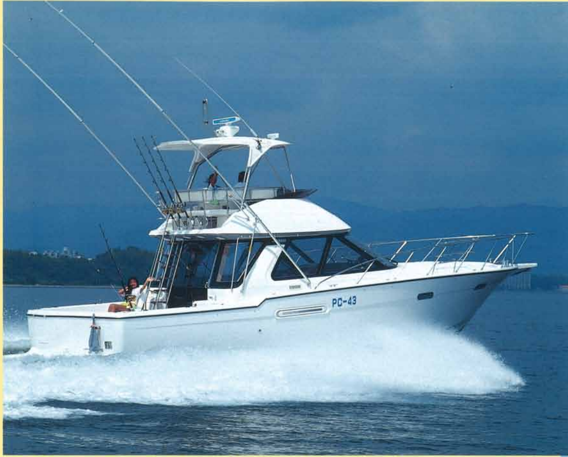
(PC-43) ●全長：14.90m ●全幅：4.22m ●全深さ：2.35m ●総トン数：16トン ●最大馬力：480PS×2 ●エンジン：SX-859KM×2 (以上計画値)
