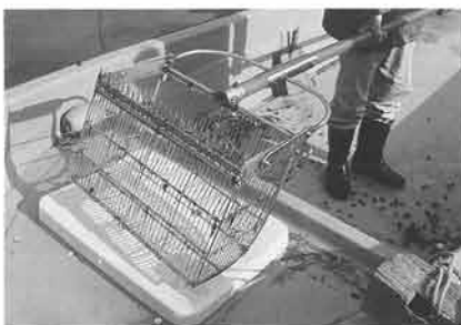
シジミ漁に使用する「ジョレン」。大きさは人によって若干異なりますが、カゴの目は11ミリと決められています
