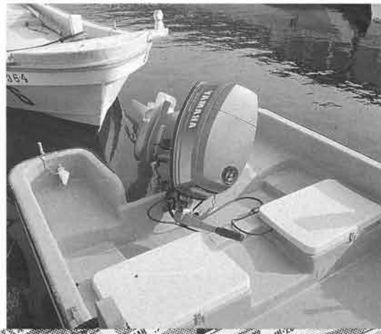
W-23DF-1。出航に、船部のもの入れなど、細かい配慮が好評です。また、パワのフェンダー、作業時にロープをひっかけるツノなど、ユーザーさんとの日頃のおつきあいの中から生まれたアイデアが活かされています。
