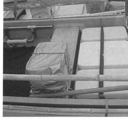
魚探据付台および配線
