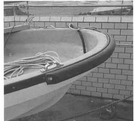
艀2次フェンダー取付け
