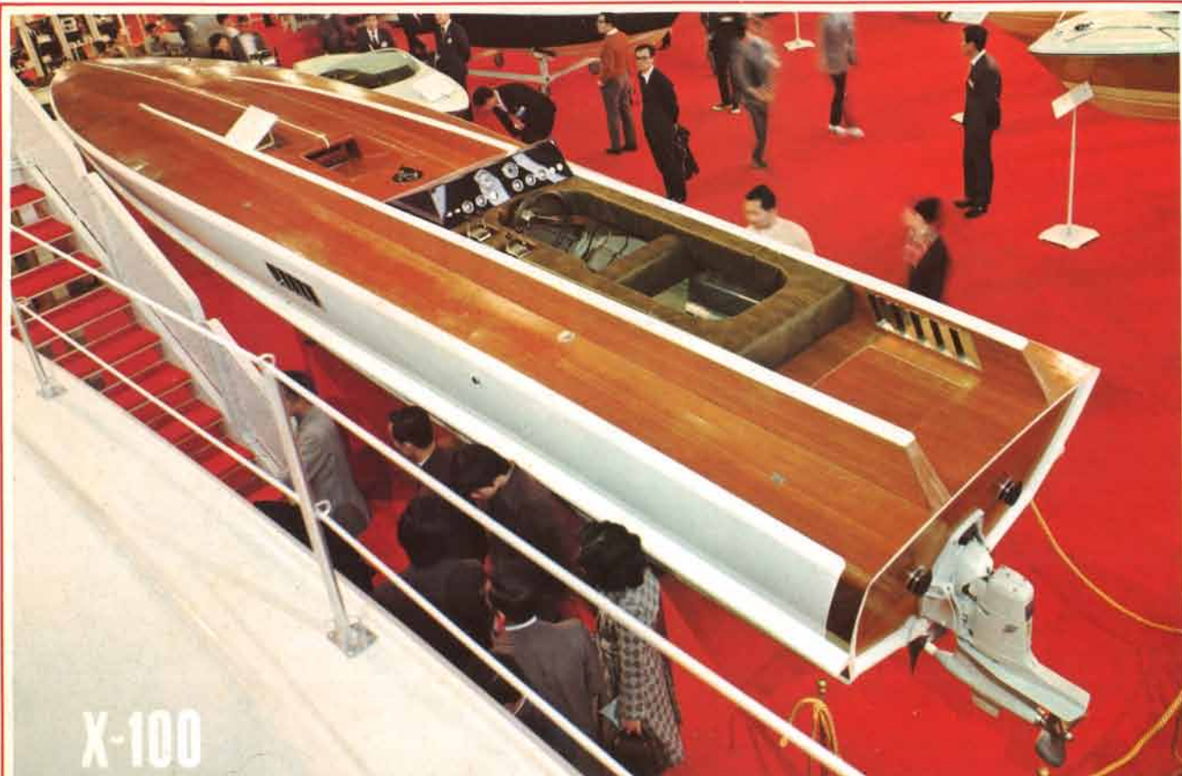
参考出品された試作艇。モーターボートの既成概念を一変させた特異なスタイリングと、タンデム方式のエンジン搭載やコントラベラなど、数々の新メカニズムをとり入れて、まさにドリームボートの実現を思わせた。
