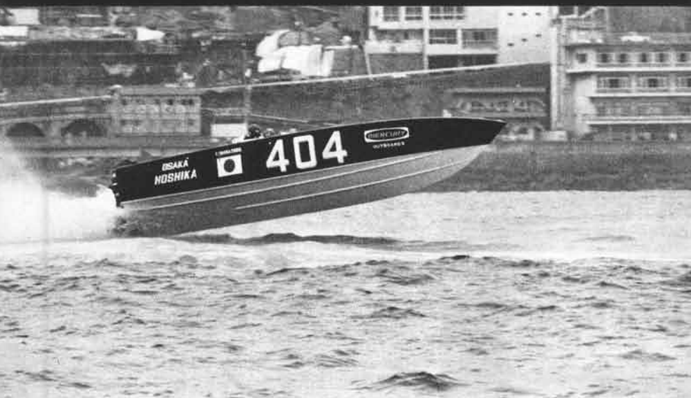
▲STR-28に船外機4基掛けという難かしいセッティングに挑戦した「404」はプロペラの損傷にもめげず総合3位に入賞した。
