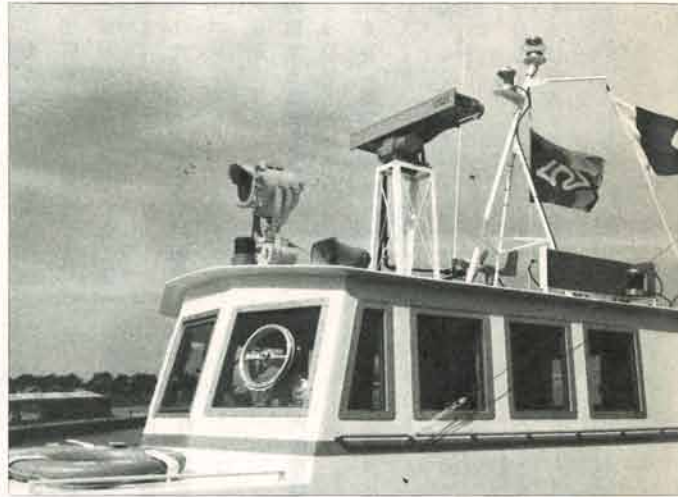
ブリッジにはレーダーをはじめ魚探、気象観測など各種の機械
