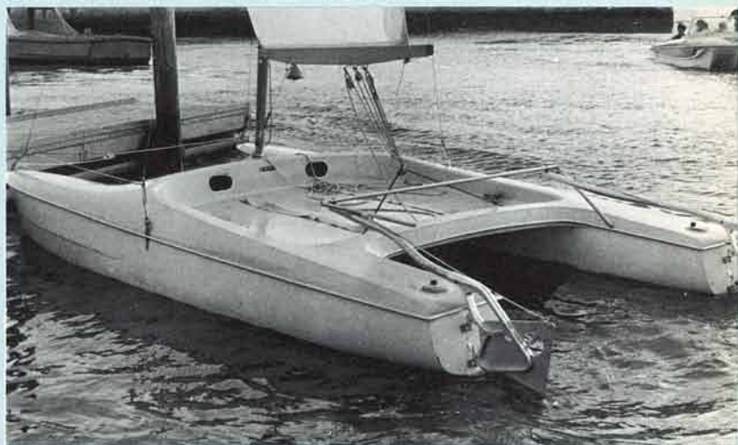
ひろびろとしたコックピット ラダーはアルミのキャストインク
