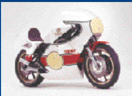
OW35 【1977年】 ポア・ストローク変更の新エンジンを搭載 吸気方式をピストンリードバルブから、ピストンバルブ方式に変更。ポア・ストロークを56×50.6へ変更し、パワージェット付きキャブレターも採用された。
