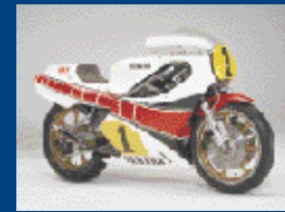
OW54【1981年】 スクエア4・ロータリーディスクバルブ搭載 ヤマハ初のスクエア4エンジンをアルミ製フレームに搭載したモデル。B・シーンにYZR500での初優勝をもたらしたオールファン思い出の一台。
