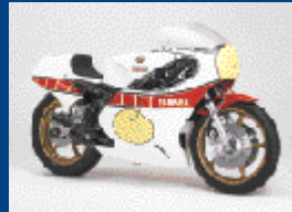
OW45 【1979年】 ピストンバルブ並列4気筒の代表マシン 排気ポートの周辺部のみをミクロン単位で切削する、ホーニングリリーフ工法を施し信頼性をアップ。80年発売の市販ロードレーサーTZ500のベース車になった。
