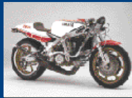
OW61【1982年】 500ccGPマシン初のV型4気筒 2ストGP500で初めてV4エンジンを搭載したマシン。デルタボックスフレームの萌芽を示すフレーム構成が特徴。同時に右側を大きく湾曲させた左右非対称リヤアームを装着した。
