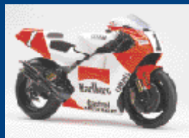
OWF2【1993年】 アルミ押し出し材フレームの採用
