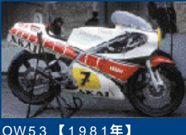
OW53 【1981年】 並列4気筒最終モデル 80年登場のOW53は、前年に登場した両外側後方排気の後継モデル。また並列4気筒エンジン搭載の最終モデルでもあった。
