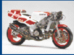
OW98【1988年】 2本出しマフラー、左右非対称リヤアーム エンジン下でクロスしたエキパイを2本とも右後方に出すレイアウトを採用。日本では平忠彦がこのマシンを駆ってV3を達成した。
