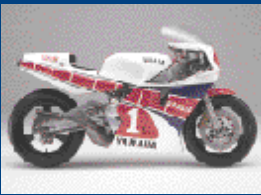
OW76【1984年】 ローソンが初タイトルを獲得 従来型のロータリーディスクバルブ吸気から、クランク室リードバルブ吸気方式へ変更。新エースのE・ローソンが、全4勝を上げて、初タイトルを獲得した。
