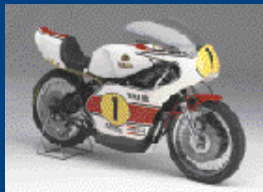
OW20 【1973~74年】 ヤマハ初の500ccファクトリーマシン 前後ディスクブレーキ採用のクロモリフレームに、水冷並列4気筒ピストンリードバルブエンジンを搭載。73年4月のフランスGPにてデビューウィンを飾る。
