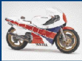
OW70【1983年】 デルタボックスフレームが登場 初のアルミ製デルタボックスフレーム採用マシン。フロント17インチ設計も初めてだった。ケニーvsスเปนサーの歴史的な死闘を演じた。
