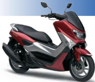
欧州を中心に人気のスクーター“TMAX”や“XMAX”のスタイルを受け継いだシティ通勤用で、“BLUE CORE”エンジンを搭載しています。インドネシアのグループ会社で生産し、日本・欧州では125cc、アセアンでは155ccの排気量で、グローバルに展開しています。
