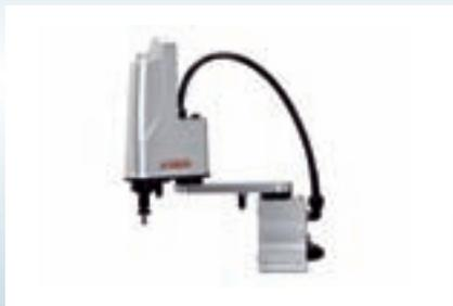
高速・高精度・低価格をコンセプトとするヤマハスカラロボットの特徴を受け継ぎながら、モーターや減速機などの機械要素や構造を見直し、高い位置決め精度とサイクルタイムの短縮を実現しました。小型ながら、重加重の作業が可能で高い剛性を発揮するなど、今後の小型スカラ型ロボット市場を拡大していくことが期待される製品です。
