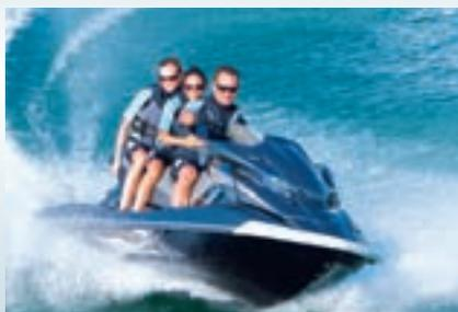
フラッグシップモデルを5年ぶりにフルモデルチェンジしました。全長を19cm延長した艇体は、優れた直進性とコーナリング性能を両立。3人がゆったりと乗船できる新形状のシートやクルーズアシストなどを採用し、長時間のクルージングに対応する快適性、機能性を追求しました。さらに、新たにニュートラルポジション付きのシフトレバーを採用し、マリナー内など狭い水域での操縦性を高めています。
