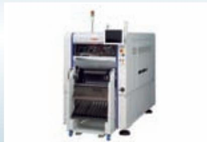
最高レベルの部品搭載速度と幅広い部品対応力を1台に集約した新しいコンセプトの下に開発された表面実装機です。スマートフォンやタブレット型端末など近年急拡大しているデジタル電子機器に内蔵される小型・中型基板に最適化した生産設備で、今後の高速機市場を拡大していくことが期待される戦略製品です。
