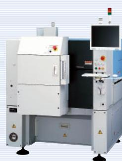
電子部品実装の現場においては生産性、先進品への対応力、設備スペース効率、経済性などが、高いレベルで求められています。「YG12F」はこれらの市場ニーズを織り込みながら、低価格化も実現した表面実装機です。
